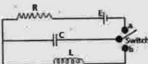
চিত্রে প্রদর্শিত বর্তনীর সুইচটি দীর্ঘ সময় ধরে 'a' র সঙ্গে যুক্ত রাখা হল। তারপরে সেটি 'b' তে যুক্ত করা হল। এর পরে যে আবর্তিত তড়িৎ প্রবাহের সৃষ্টি হবে তার বিষ্ণার
